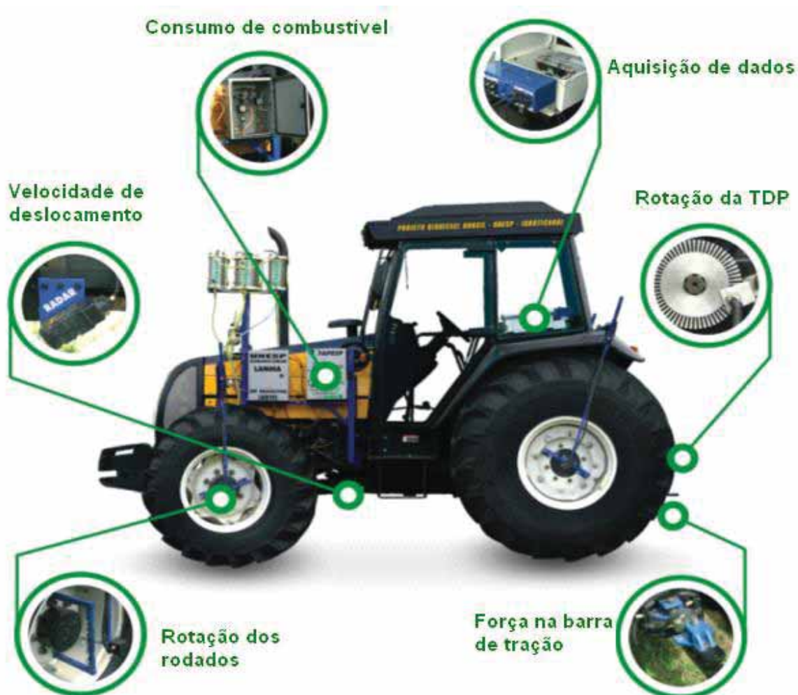
FIGURA 2. Vista lateral do trator de teste com instrumentação completa.
