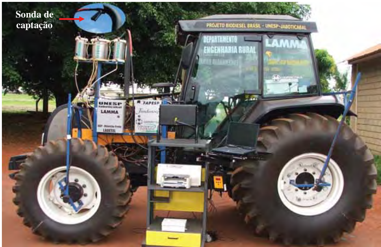
FIGURA 4. Vista geral do trator instrumentado para o ensaio de opacidade da fumaça. Fonte: LOPES (2006)
