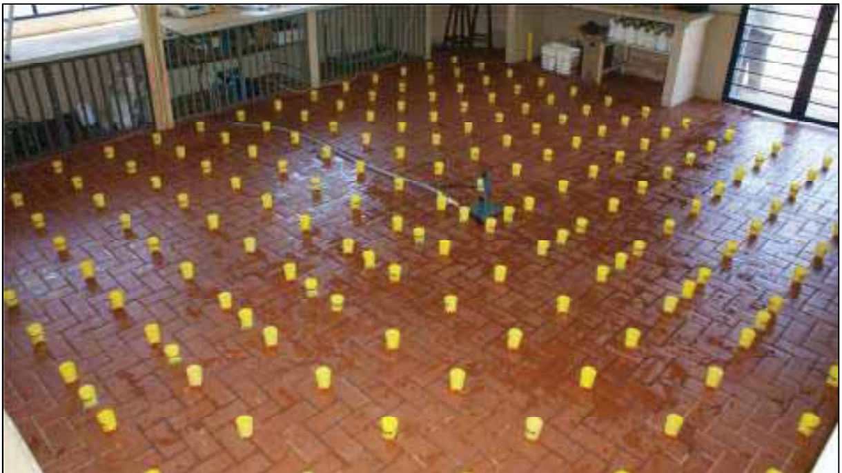
Figura 14. Disposição dos coletores para ensaio de uniformidade de distribuição.
