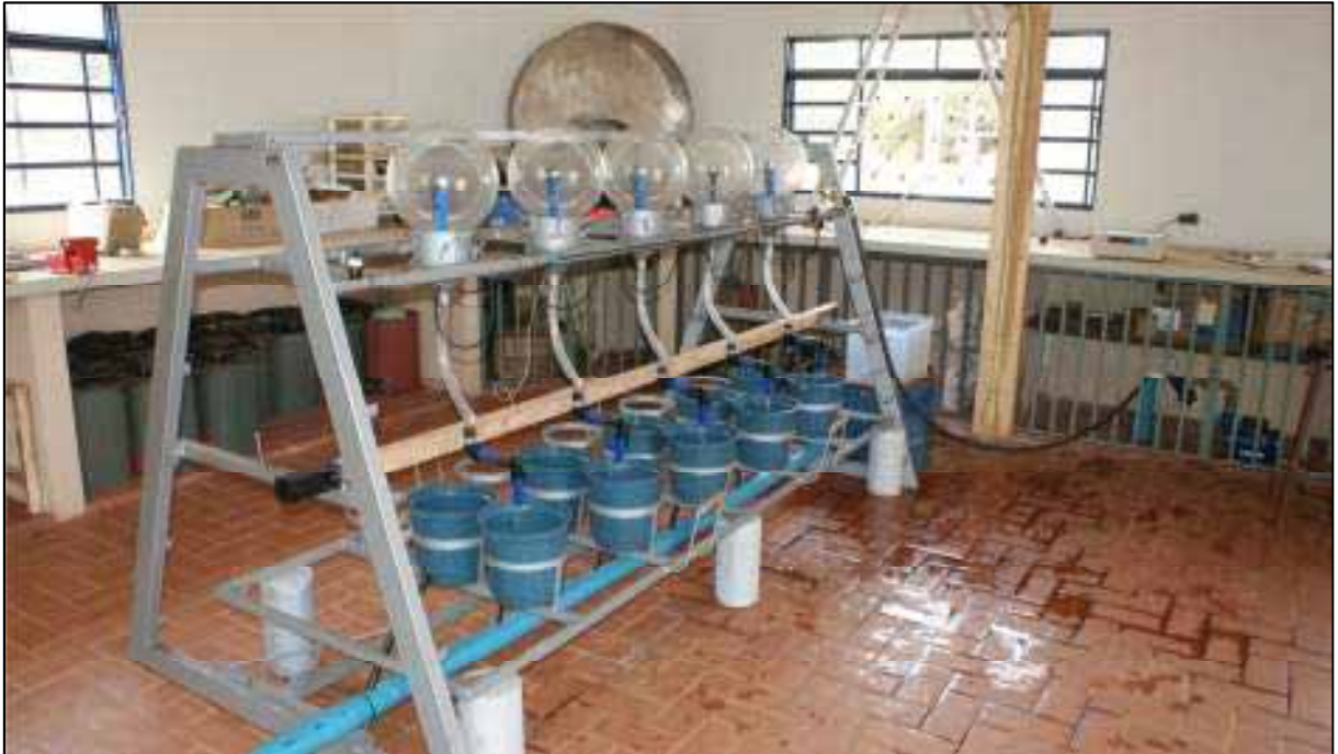
Figura 4. Bancada de ensaio de uniformidade de vazão.
