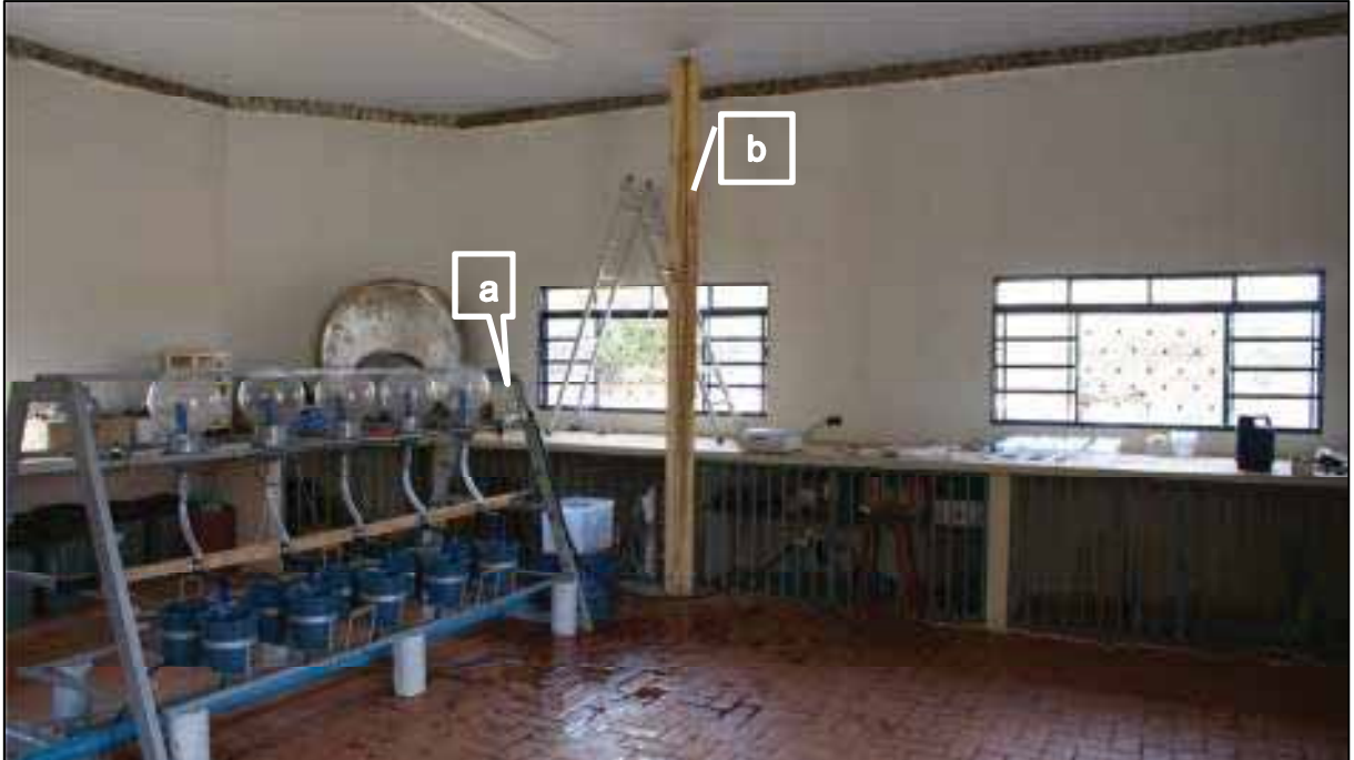
Figura 15. Ilustração do manômetro de Bourdon (a) e de coluna de mercúrio (b).
