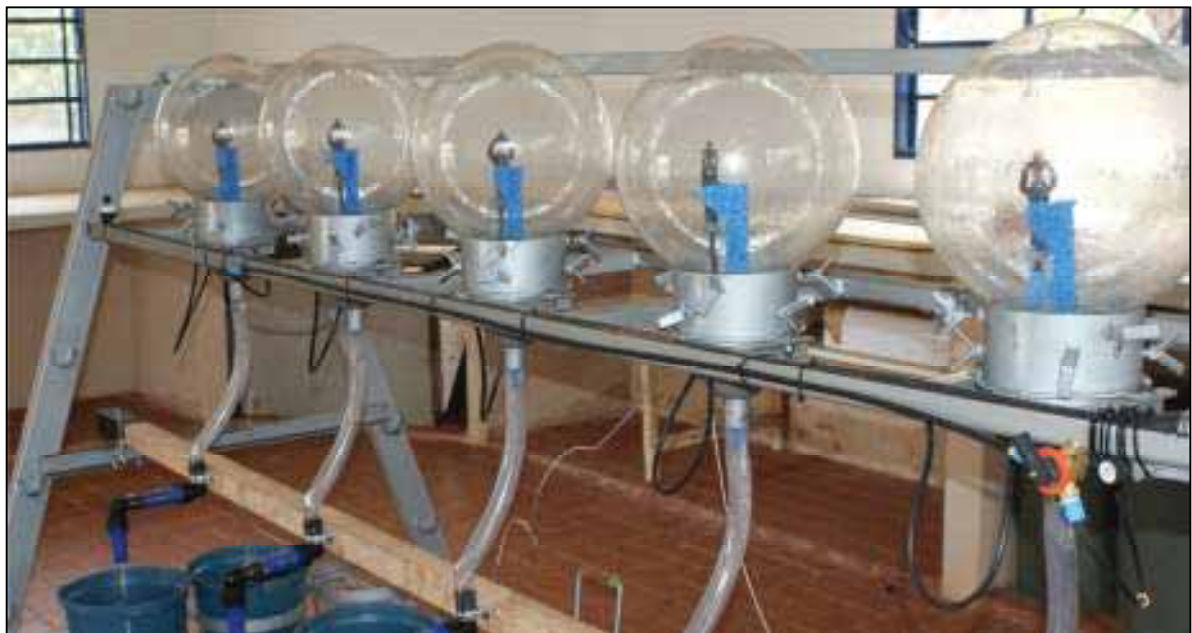
Figura 5. Detalhe da bancada, cúpula e dispositivo de alojamento.
