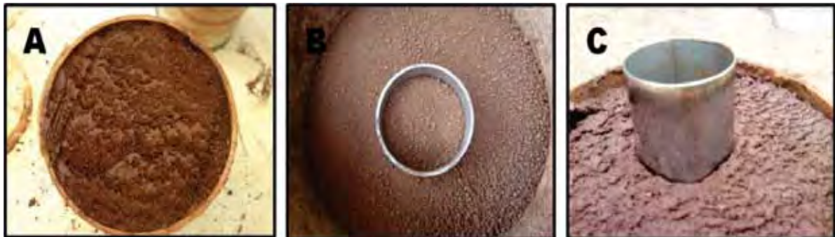
Figura 1. Medições da densidade aparente realizado através do método do anel volumétrico. A) Anél de PVC preenchido com solo. B) Anél de Kopecky, utilizado para retirar amostras de solo indeformado. C) Vista lateral do anel de Kopecky utilizado na retirada de amostras de solo indeformado. Jaboticabal, UNESP, 2012.
