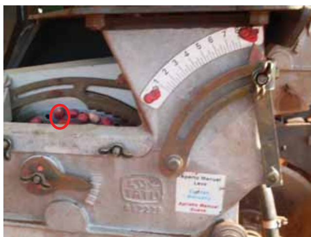
Figura 17. Disco dosador pneumático da semeadora indicando a falta de semente no furo, quando na densidade de semeadura de 18 sementes m^{-1} .
