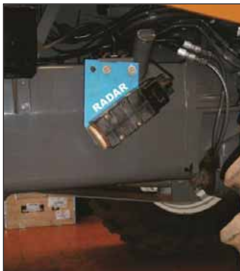
Figura 6. Radar utilizado para aferição da velocidade de deslocamento.
