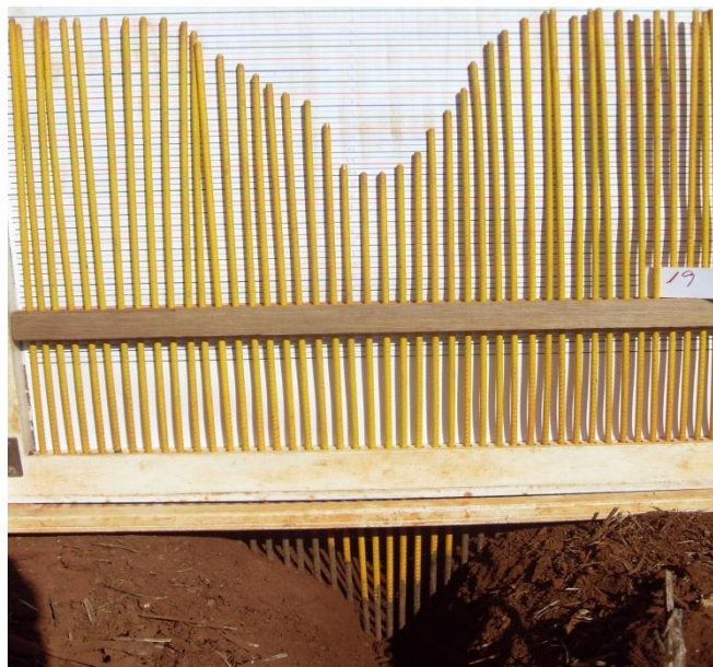
Figura 11. Perfilômetro de varetas para determinar a mobilização do solo.
