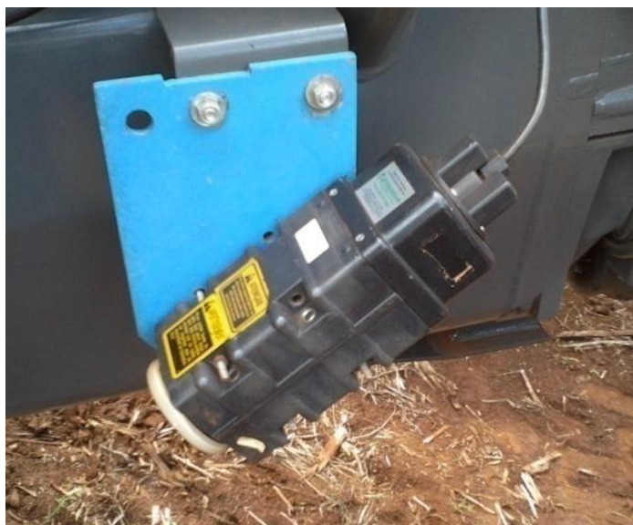
Figura 7. Radar alinhado com ângulo de 45° em relação ao solo.
