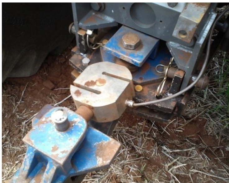
Figura 8. Célula de carga com capacidade para 100 kN utilizada para determinação da força na barra de tração.
