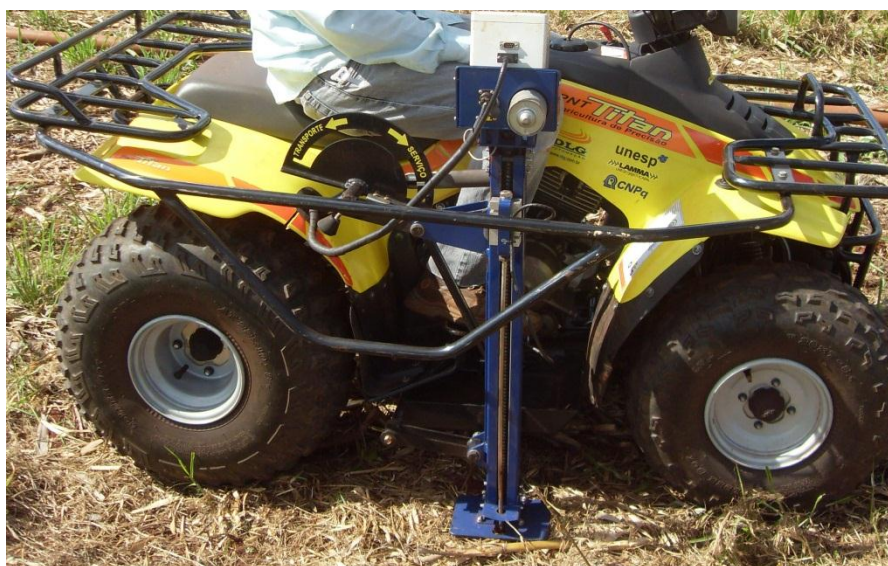
Figura 10. Penetrômetro eletrônico acoplado a um quadriciclo.
