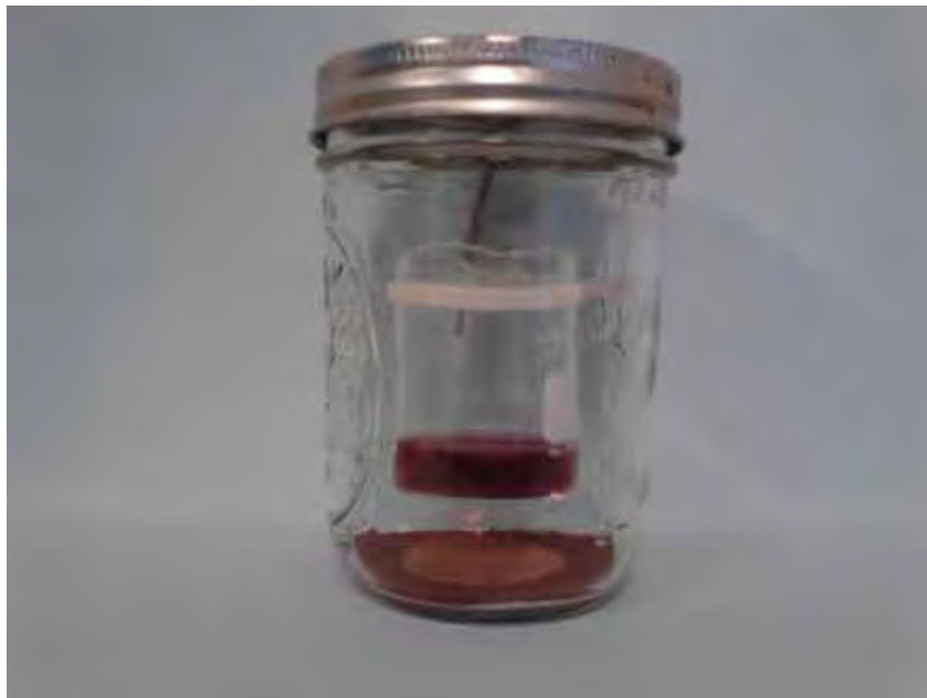
Figura 1. Recipiente com tampa de fechamento hermético (Mason jar) com as adaptações necessárias para determinação de N pelo método de Illinois (ISNT).
