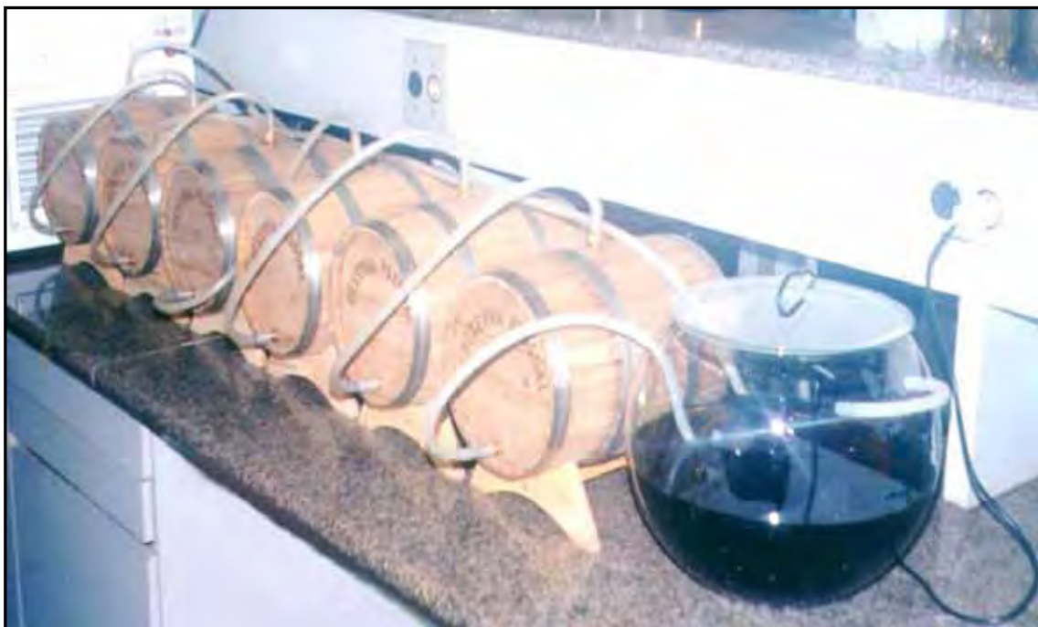
Figura 2 - Sistema utilizado para a circulação do destilado alcoólico
