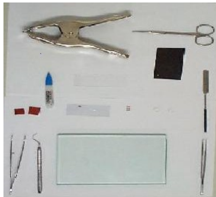
Figura 16: Material e instrumental utilizados na colagem do extensômetro na amostra.
