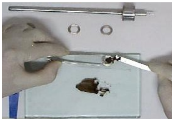
Figura 8: Foto mostrando preparação de amostras para medida de tempo de presa.
