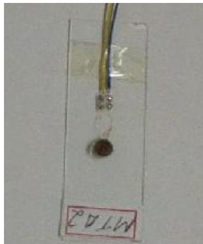
Figura 17: Amostra com extensômetro colado em sua superfície.
