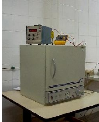
Figura 19: Sistema utilizado para medidas de expansão térmica.
