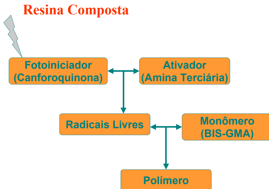
Figura 2: Diagrama representando o processo de polimerização em compósitos fotoativados.
