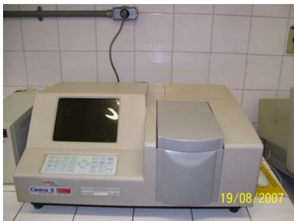
Figura 18. Espectrofotômetro Cintra 5 UV-VIS “DoubleBeam” utilizado na determinação da pureza do PHB.
