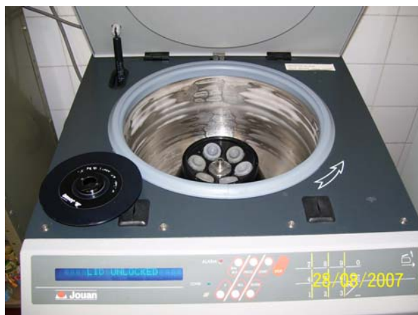
Figura 14. Centrífuga (Jouan GR20.22) utilizada na separação da massa celular do caldo fermentado.
