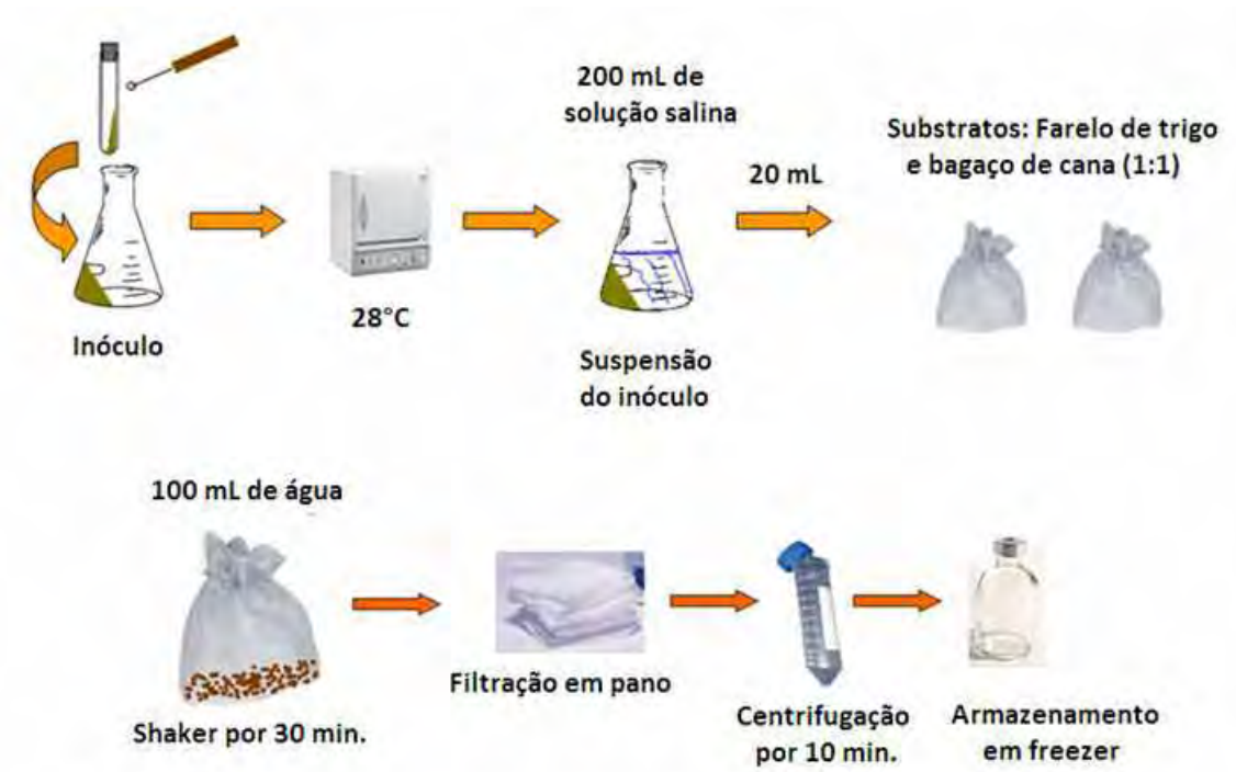
Figura 11: Esquema de fermentação em estado sólido e extração de enzima.
