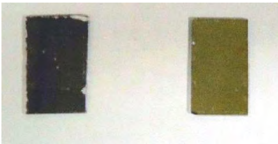
Figura11 – Fotos de heterojunções de Al/GaAs vistas através do substrato de vidro. Do lado esquerdo está uma heterojunção sem TT, e a direita outra heterojunção com o TT em atmosfera de O 2 .
