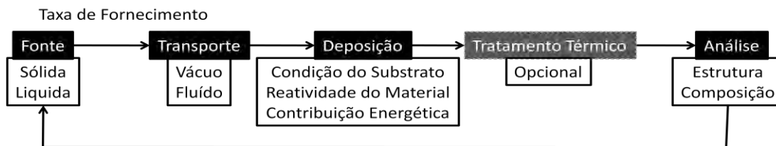
Figura 3 – Etapas do processo de formação dos filmes finos (adaptada de Smith,1995).
