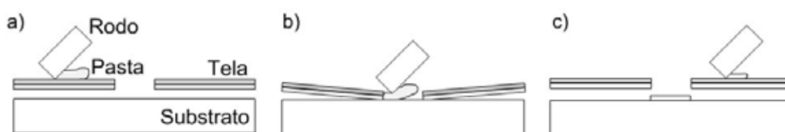
Figura 4.1.3 Processo de deposição por screen-printing : (a) esquema do sistema de deposição; (b) passagem do rodo contra os fios da malha e (c) pasta depositada.
