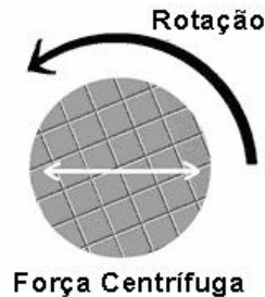
Figura 2.22 – Força de espalhamento do material sobre o substrato (BREWER SCIENCE, 2006)
