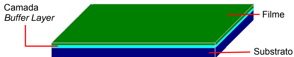
Figura 2.3 – Estrutura de um filme fino possuindo uma camada buffer layer
