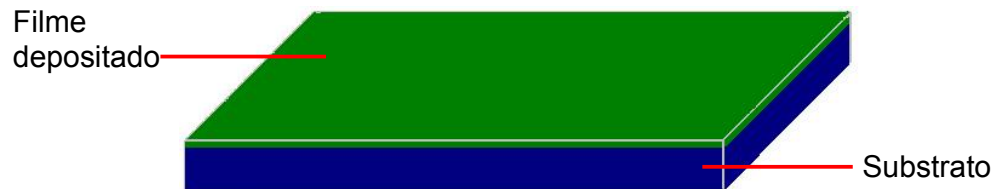
Figura 2.1 – Estrutura de um filme fino
