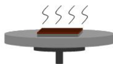
Figura 2.21 – Evaporação do solvente contido sobre o substrato (BREWER SCIENCE, 2006)
