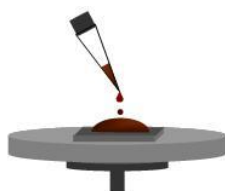
Figura 2.19 – Deposição de solução química sobre o substrato (BREWER SCIENCE, 2006)
