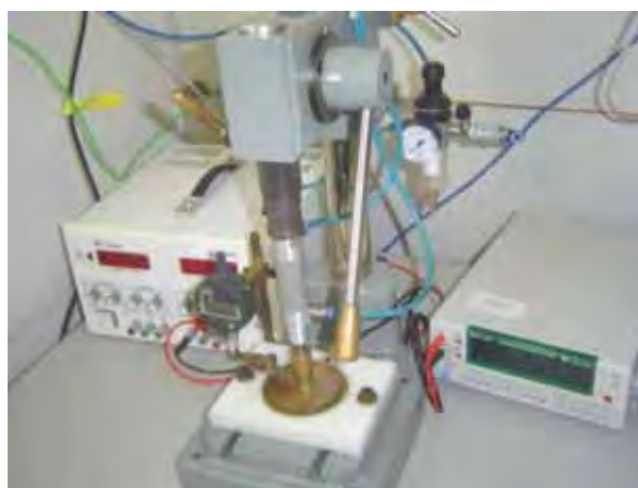
Figura 13: Fotografia do equipamento utilizado para determinar a condutividade elétrica de volume das amostras.
