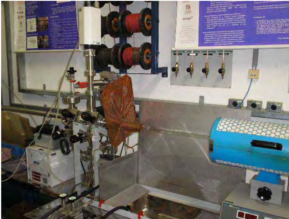
Figura 32 – Fotografia do sistema de tratamentos térmicos e dopagens de amostras.
