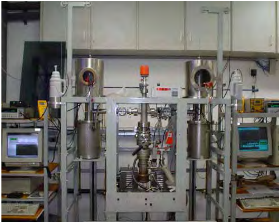
Figura 26 - Fotografia do sistema de medidas de atrito interno.
