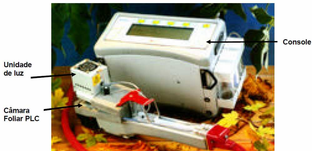
Figura 1. Aparelho LCpro+ mostrando os principais componentes: Console, Câmara Foliar PLC e Unidade removível de luz.
