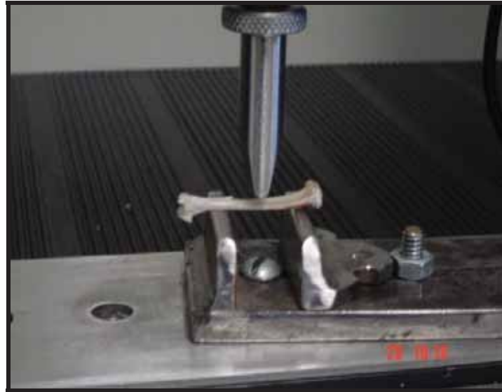
Figura 7. Ensaio biomecânico de flexão em três pontos. Tibia apoiada em dois pontos e a força aplicada em um terceiro ponto, no meio geométrico entre os dois apoios. Fonte: BIFFE, B.G.,2011.
