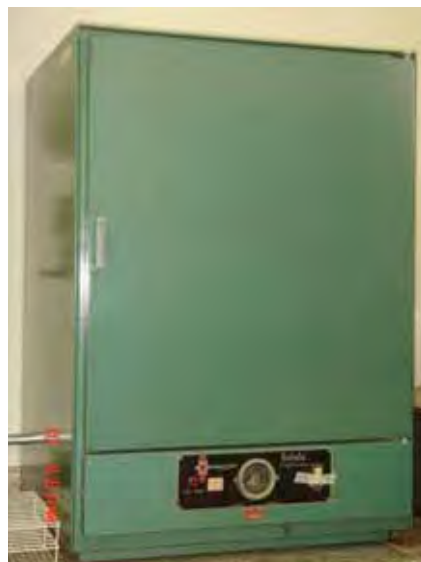
FIGURA 10 - Estufa bacteriológica Favem Ltda modelo retilínea, onde os tubos de ensaio permanecerão durante o tempo de incubação.
