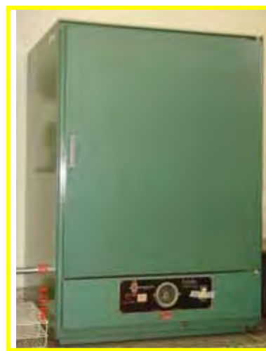
FIGURA 9 - Estufa bacteriológica Favem LTDA modelo retilínea, onde os tubos de ensaio permanecerão durante o tempo de incubação.
