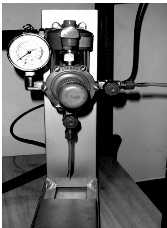
Figura 4.6: Válvula reguladora da vazão de ar.
