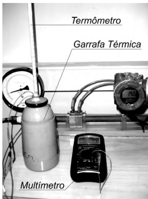
Figura 4.10: Poço de medição de pressão e de temperatura.
