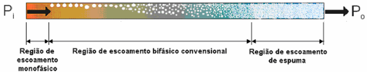
Figura 3.1 – Regimes de escoamento da mistura óleo-refrigerante.
