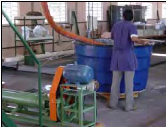
Figura 43: Bomba helicoidal Geremias - 7,5 CV.
