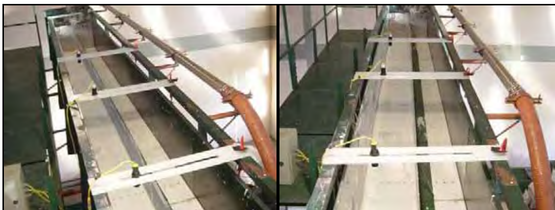
Figura 45: Plataforma equipada com sensores ultra-sônicos e septo divisorio na seção.
