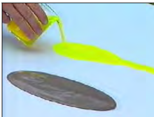
Figura 9: Escoamento de lama (não-Newtoniana) e água com corante (Newtoniana).
