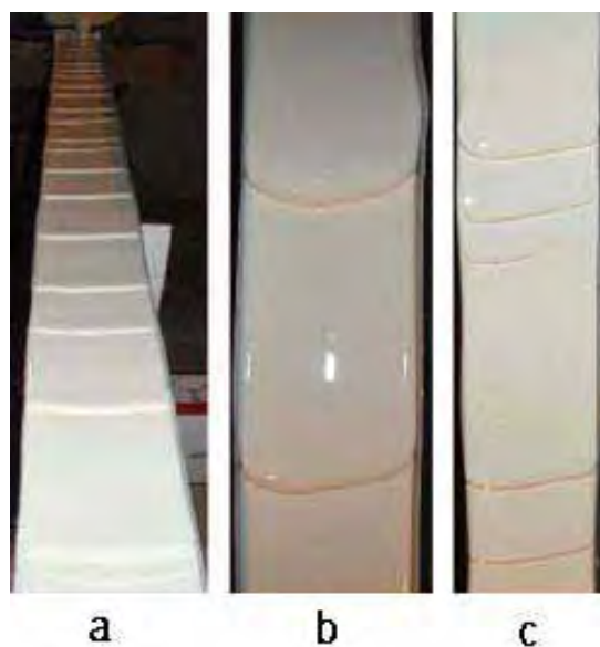
Figura 15: (a) visão típica experimental da formação de Roll Waves . (b) visão detalhada de um par de ondas, (c) formação de um trem de ondas com a variação da inclinação do canal.
