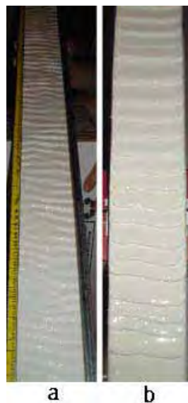
Figura 16: (a) Roll Waves com amido de milho dois dias depois de preparado, (b) Roll Waves com amido de milho dois dias depois de preparados com uma inclinação maior do que na figura 16 (a)
