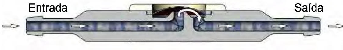
Fig. 3.4 – Representação do escoamento através do dispositivo.
