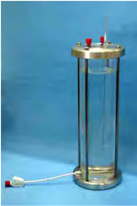
Fig. A.2 – Reservatório (Frasco de Mariotte).
