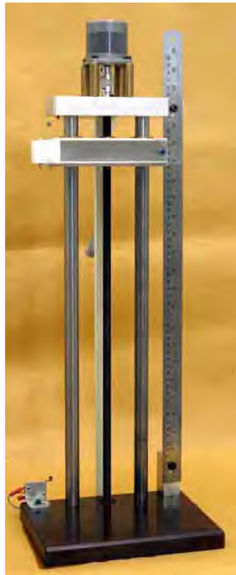
Fig. A.3 - Mecanismo, para deslocamento linear vertical, utilizado nos experimentos.
