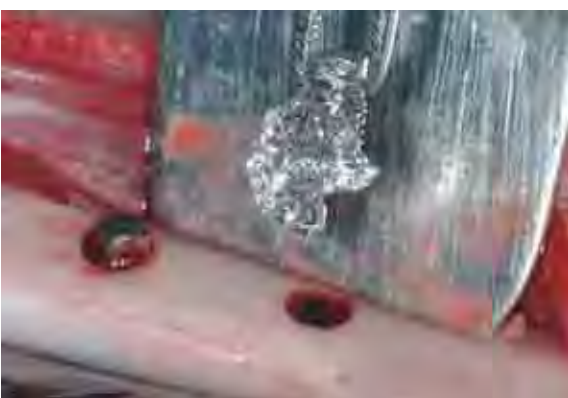
Figura 47 - Instalação do implante envolto com PLA/PGA, sem estabilidade primária.
