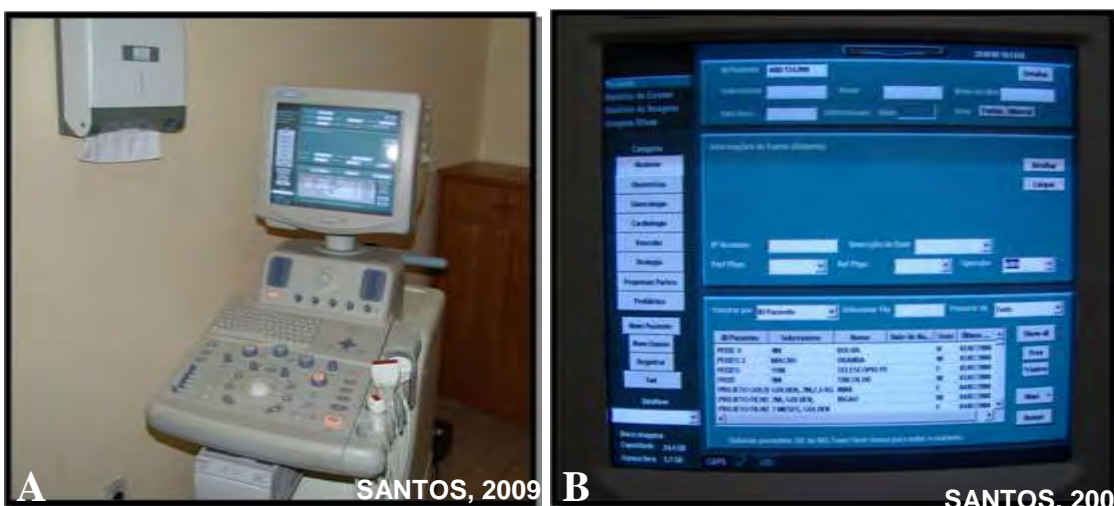
FIGURA 25. Aparelho de ultrassonografia marca GE 1 - modelo LOGIG 3, equipados com transdutores convexo de 3,5-5,0MHz e linear de 6-10MHz (A), identificação dos animais no aparelho de ultrassonografia (B).
