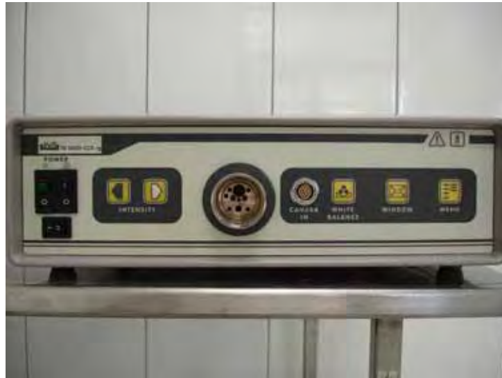
Figura 2- Imagem fotográfica do aparelho que emite fonte de luz de xenon acoplada à microcâmara.
