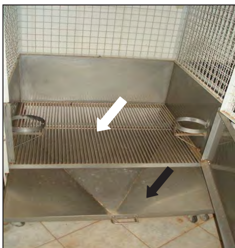
Figura 2. Gaiola metabólica para cães, (seta branca) aparato de coleta de fezes, (seta preta) aparato de coleta de urina.
