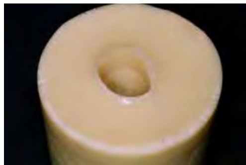
FIGURA 9 – Modelo de poliuretano após o dente e a cera serem removidos
