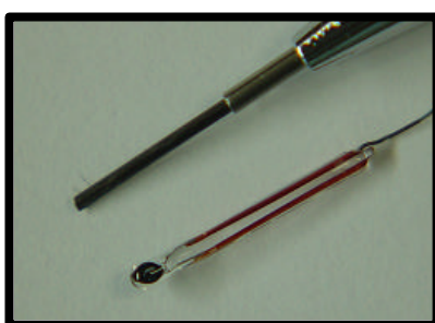
Figura 10 – Termistor comparado à ponta de uma grafite 0,7
