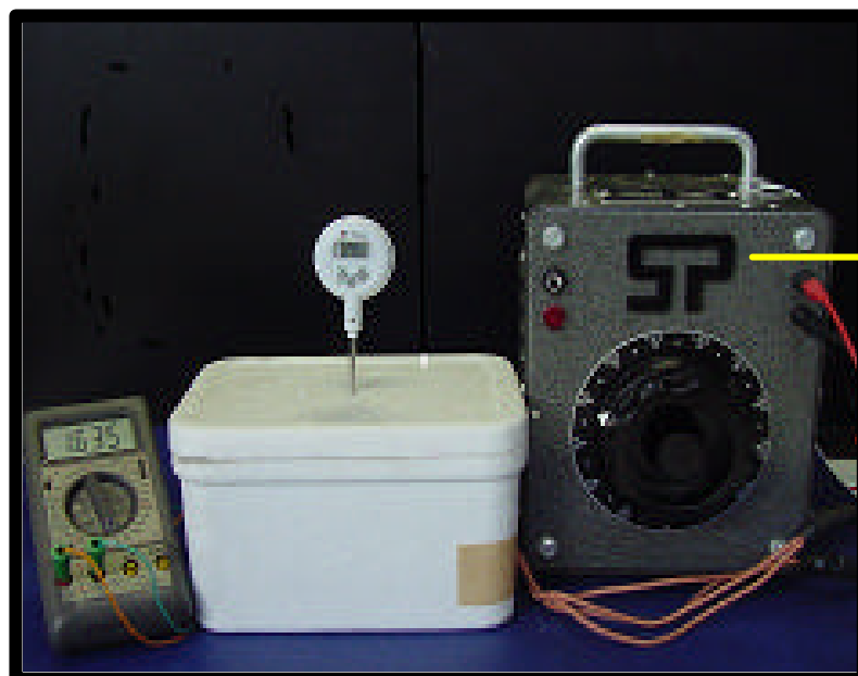
Figura 12- Calibração da matriz metálica
