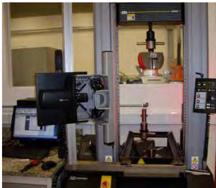
FIGURA 24 - Máquina de ensaio mecânico - Instron 5569.
