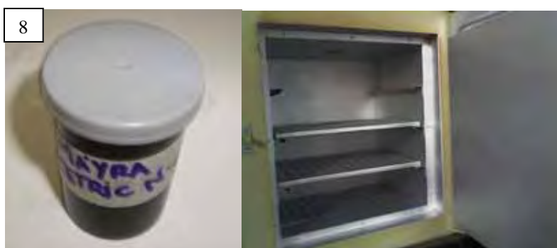
FIGURA 8 –Armazenamento em estufa 37°C por 24hs.
