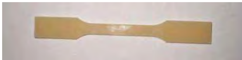
FIGURA 20 – Corpo de prova após remoção das rebarbas.
