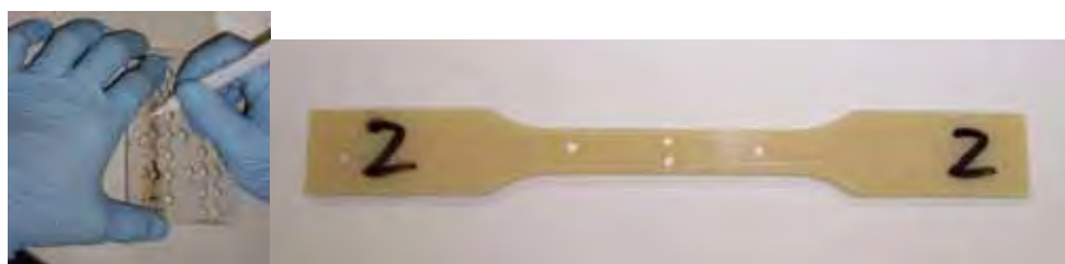
Figura 21 – Marcação dos quatro pontos com gabarito.
