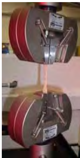
FIGURA 22 – Fixação do corpo de prova nas pinças.
