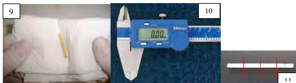
FIGURA 9 - Secagem com papel absorvente. FIGURA 10 - Paquímetro digital. FIGURA 11 - 3 medidas de altura e 3 de largura.
