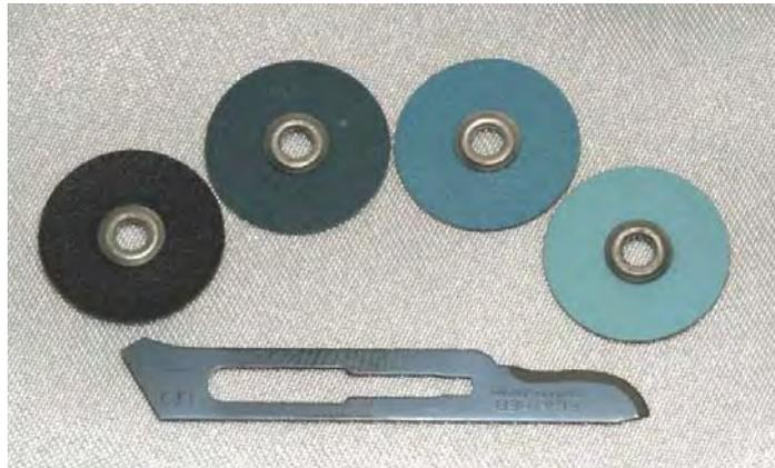
FIGURA 13 – Materiais para acabamento e polimento dos espécimes.
