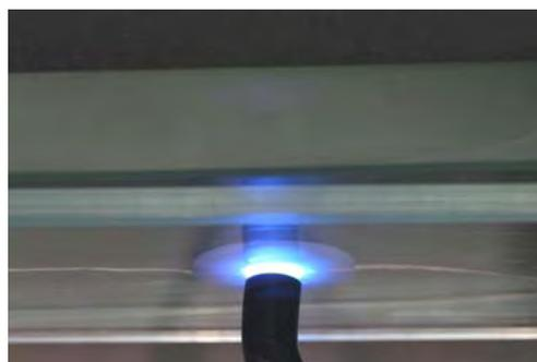
FIGURA 10b – Fotopolimerização do material através da placa de vidro inferior.
