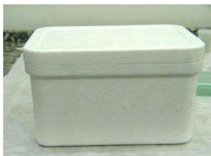
FIGURA 12 – Armazenamento dos espécimes em umidade relativa 100%.
