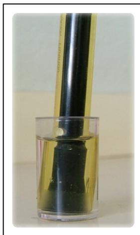
FIGURA 17 – Eletrodo F específico Orion modelo 9609-BN.
