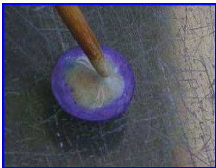
FIGURA 13- Aplicação do pó manipulado sobre a barbotina.
