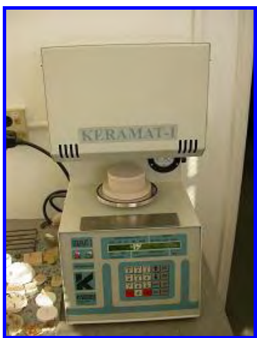
FIGURA 64- Apresentação do forno Keramat-I, utilizado para a sinterização da cerâmica de estratificação do Empress 2.
