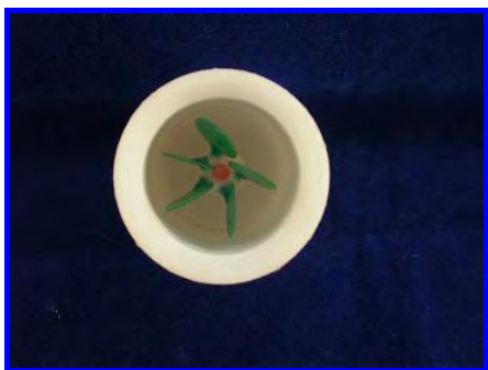
FIGURA 35- Vista das pastilhas em cera, fixadas ao cilindro de injeção, dentro do cilindro de revestimento.
