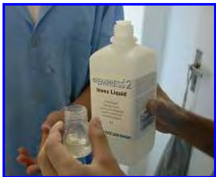
FIGURA 57- Corpos de prova dentro de um recipiente, submersos em líquido InVex, para a limpeza em ultrassom.
