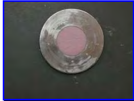
FIGURA 25- Aplicação concluída, com o auxílio da matriz metálica com 1,5 mm de espessura.
