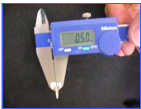
FIGURA 20- Mensuração da espessura dos corpos de prova do material de infra-estrutura do sistema In-Ceram.
