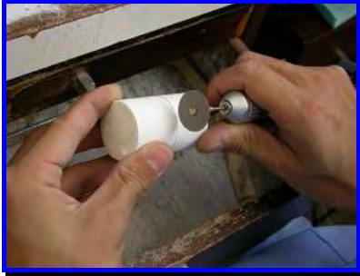
FIGURA 49- Início do corte dos cilindros para remoção dos corpos de prova.
