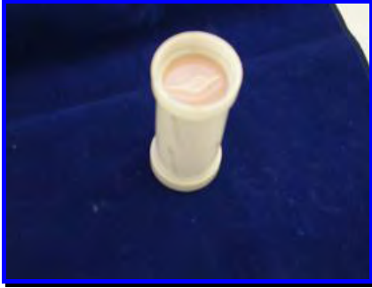
FIGURA 37- Cilindro preenchido, aguardando a presa do material de revestimento.
