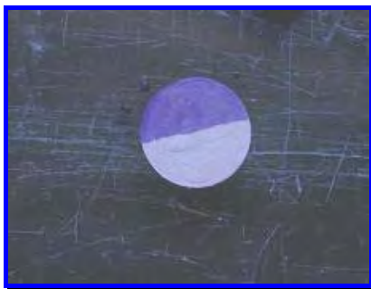
FIGURA 9- Comprovação do material com o líquido de controle para averiguação de trincas.
