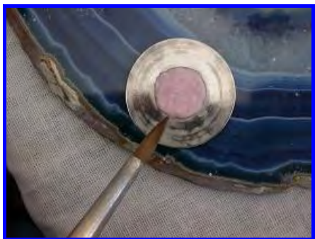
FIGURA 62- Aplicação da cerâmica de estratificação concluída.
