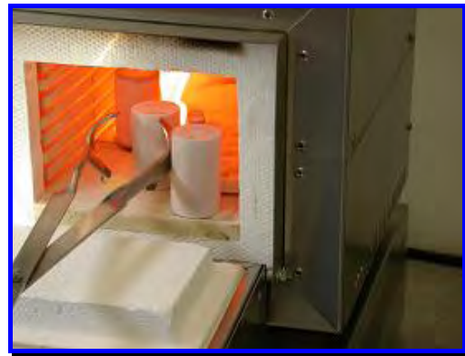
FIGURA 40- Vista dos cilindros no interior do forno para a fundição da cera.
