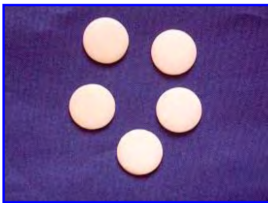
FIGURA 28- Corpos de prova prontos, com 1,5 mm de espessura e 13 mm de diâmetro.
