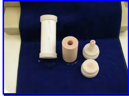
FIGURA 38- Cilindro desmontado após a presa do material de revestimento.
