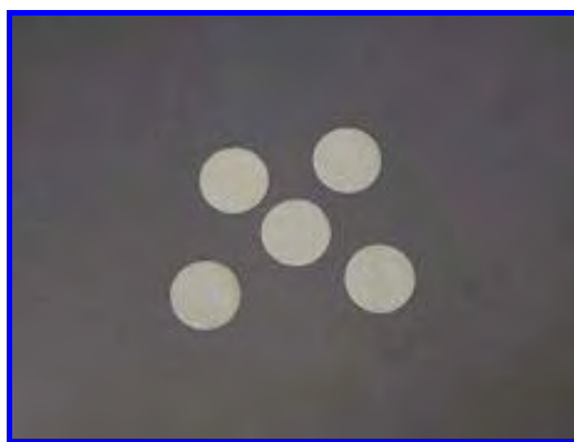
FIGURA 21- Corpos de prova do material de infra-estrutura do sistema In-Ceram com 0,5 mm de espessura e 13 mm de diâmetro concluídos.
