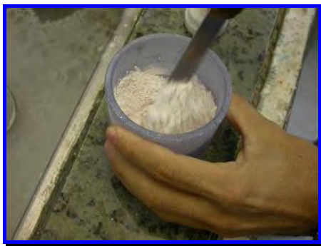
FIGURA 33- Mistura do pó ao líquido do material de revestimento, devidamente dosados.
