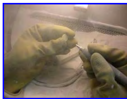
FIGURA 19- Jateamento dos corpos de prova com óxido de alumínio para remoção de excessos de vidro.
