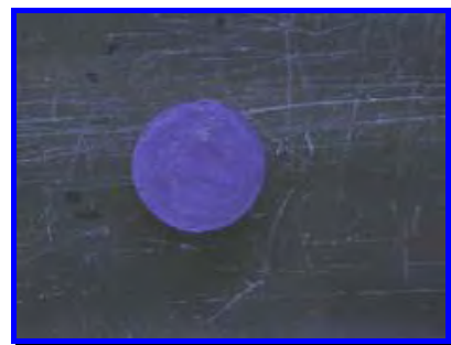
FIGURA 10- Observação da ausência de trincas.
