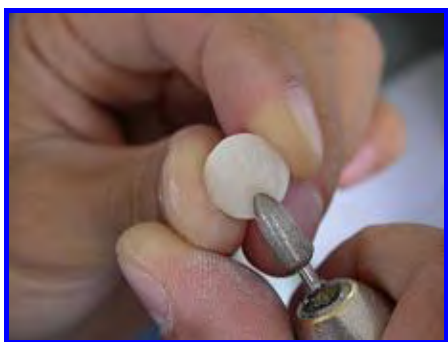
FIGURA 66- Desgaste do corpo de prova para adquirir a espessura desejada de 1,5 mm.
