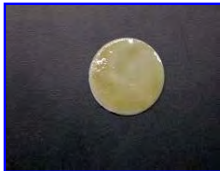
FIGURA 16- Corpo de prova sinterizado, após o resfriamento.
