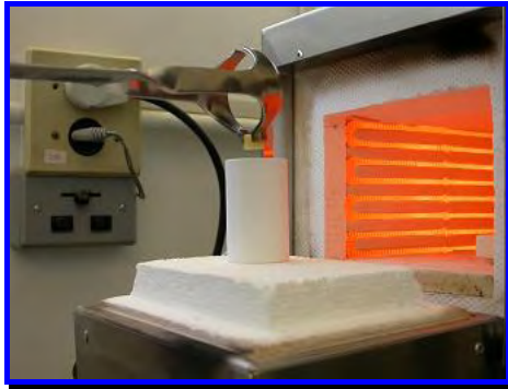
FIGURA 43- Inserção da pastilha no cilindro após a eliminação da cera fundida.
