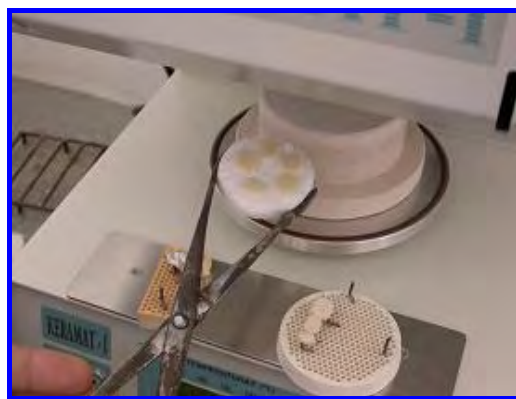
FIGURA 65- Remoção dos corpos de prova do forno após a sinterização.
