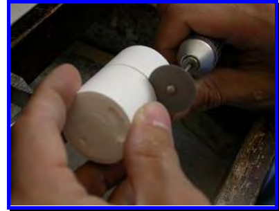
FIGURA 50- Detalhe da marca no cilindro para evitar que o corte atinja os corpos de prova.
