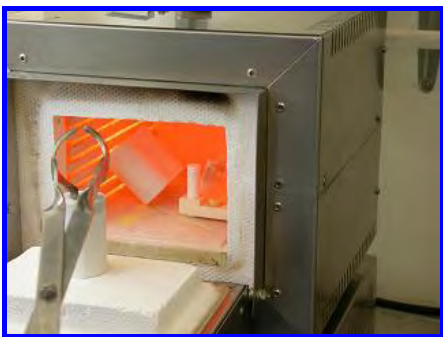
FIGURA 41- Remoção dos cilindros após a fundição e eliminação da cera.
