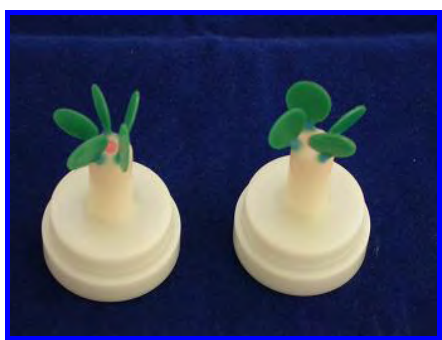
FIGURA 29- Pastilhas em cera, fixadas ao cilindro de injeção.
