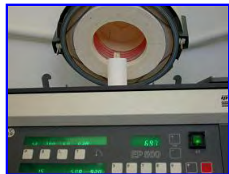
FIGURA 48- Cilindro montado e posicionado no forno para a injeção.
