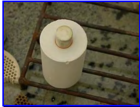
FIGURA 46- Vista do conjunto montado (cilindro, êmbolo e pastilha).
