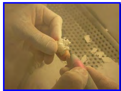
FIGURA 52- Jateamento para remover o material que está preso entre os corpos de prova.
