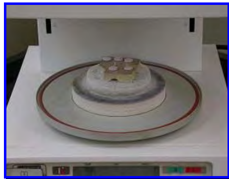
FIGURA 27- Corpos de prova no forno Ney Centurion VPC no momento da sinterização.
