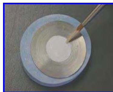
FIGURA 6- Aplicação da barbotina na matriz metálica.
