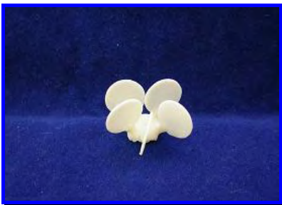
FIGURA 53- Apresentação dos corpos de prova após a remoção do material de revestimento.
