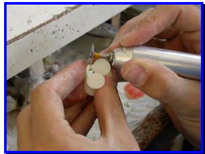
FIGURA 54- Corte dos ductos de alimentação para os corpos de prova.
