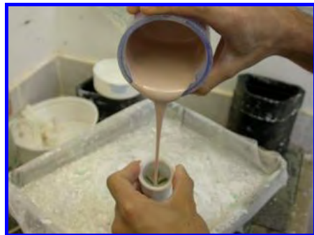
FIGURA 36- Preenchimento do cilindro com material de revestimento manipulado.
