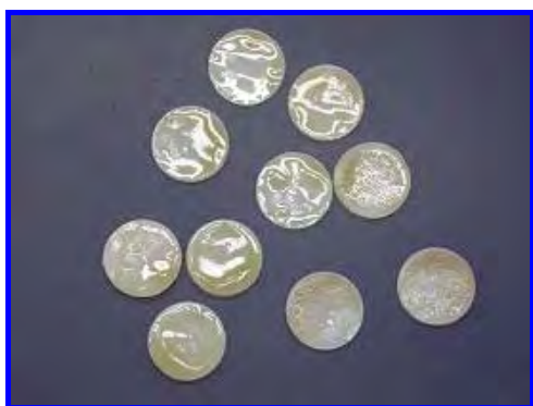
FIGURA 17- 10 corpos de prova removidos do forno, logo após a sinterização de infiltração.
