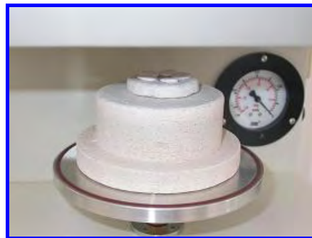
FIGURA 63- Corpos de prova cobertos com a cerâmica de estratificação posicionados no forno para a sinterização.
