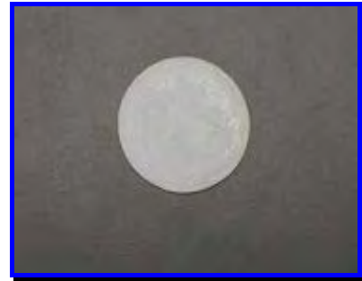
FIGURA 8- Barbotina após a sinterização.
