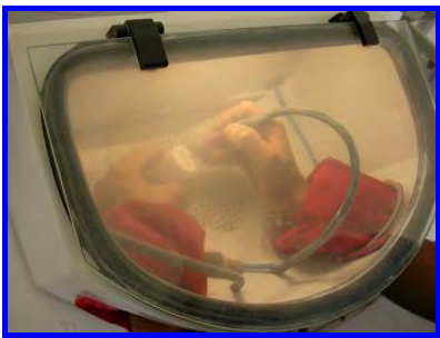
FIGURA 51- Jateamento para remover o material de revestimento que está cobrindo os corpos de prova.
