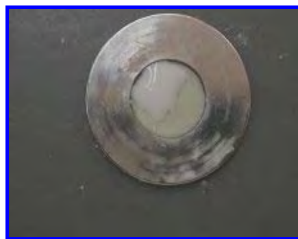
FIGURA 23- Aplicação de uma fina camada de dentina opaca A1 sobre o corpo de prova do material de infra-estrutura.
