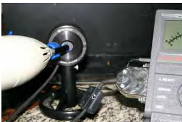
FIGURA 7 - Aparelho halógeno posicionado na ponta aferidora.
