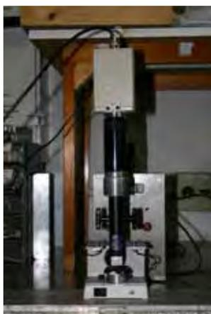
FIGURA 26 - Câmera de vídeo digital CCD (charged-coupled device) modelo GC-405 N-G LG-Honeywell, posicionada sobre a lupa óptica monocular.
