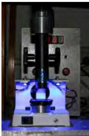
FIGURA 25 - Lupa óptica monocular posicionada sobre um iluminador de LEDS azuis.
