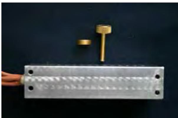
FIGURA 9 - Matriz de alumínio com pino e um espaçador de 4 mm de espessura.
