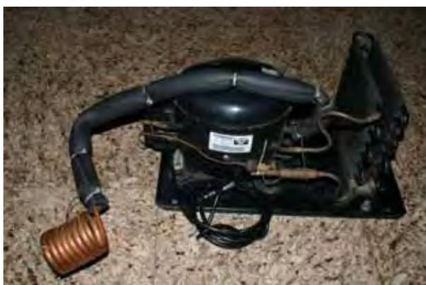
FIGURA 12 - Sistema de refrigeração utilizado para resfriamento da matriz até 0 °C.
