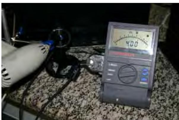
FIGURA 6 - Potenciômetro utilizado para aferir a potência dos aparelhos
