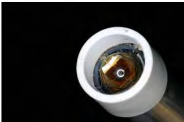
FIGURA 5 - Diodo localizado na ponta do aparelho LED 1.
