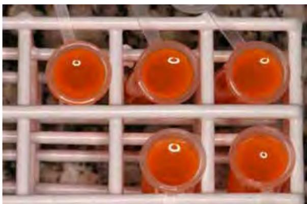
FIGURA 17 - Tubos de Eppendorf preenchidos com rodamina 6G em etilienoglicol a 0,1% prontos para receberem os corpos de prova.
