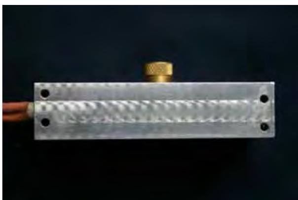
FIGURA 10 - Matriz com o pino e o espaçador posicionado na região inferior.
