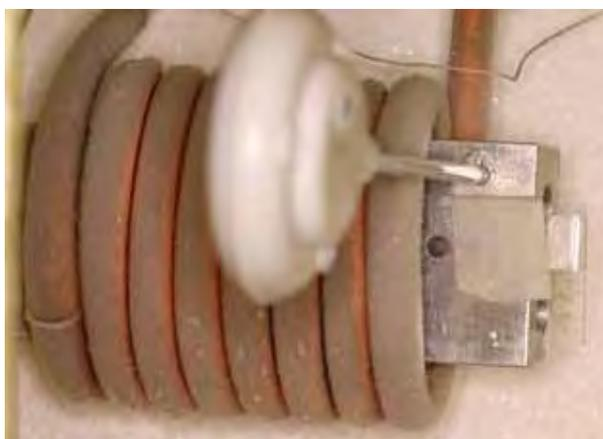
FIGURA 13 - Matriz com o termômetro posicionado na serpentina.
