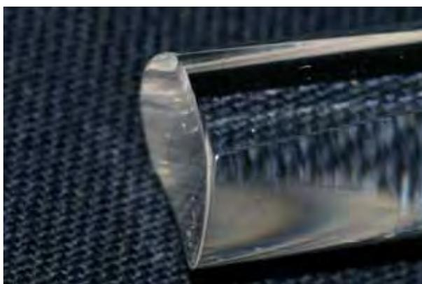
FIGURA 3 - Ponta transmissora número 2 do aparelho LED 2.
