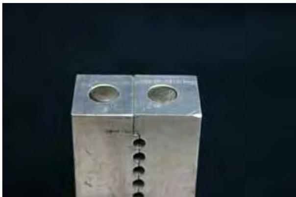
FIGURA 15 - Matriz de alumínio atravessada por duas resistências.
