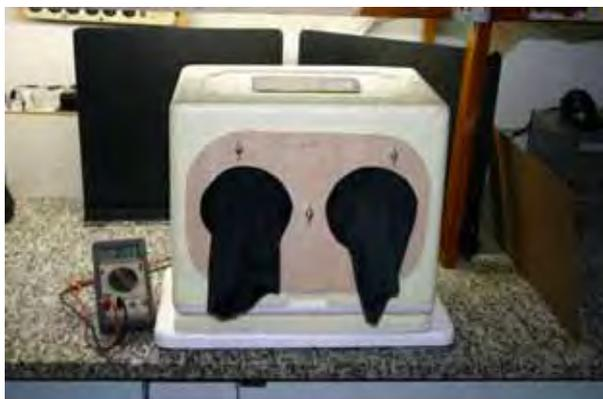
FIGURA 14 - Caixa térmica utilizada para confecção das amostras em todas as temperaturas de cura propostas.
