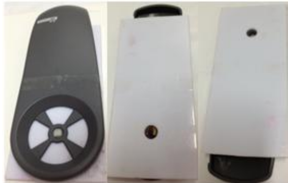
Figura 12 – Base para inserção dos corpos de prova durante a leitura.
