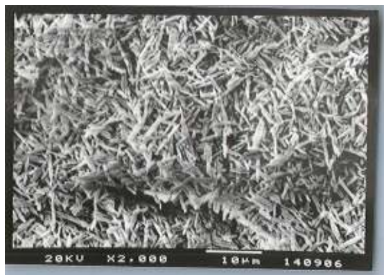
FIGURA 41 – IPS Empress II ácido fluorídrico a 10%.
