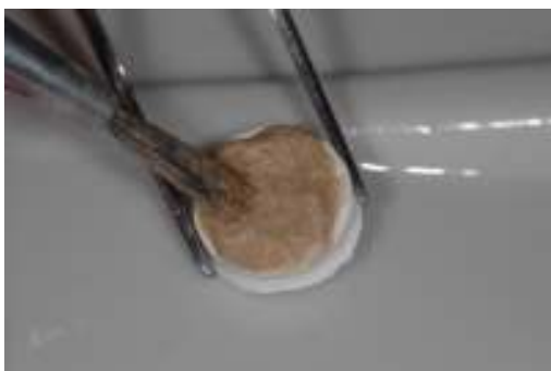
FIGURA 20 – Camada de pó de vidro.
