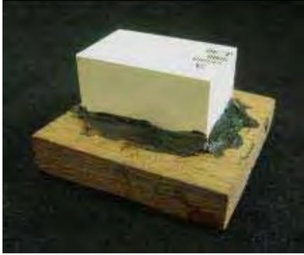
**FIGURA 1 - Fixação do bloco a base de madeira**
