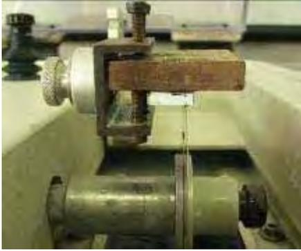
**FIGURA 5 – Posicionamento das laminas para obtenção dos corpos de prova**
