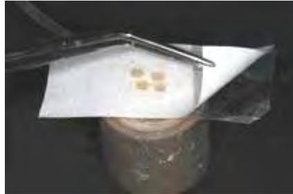
Figura 6 - Matriz cilíndrica passando por dentro do dispositivo, um bisturi era inserido na fenda para realizar o corte.
