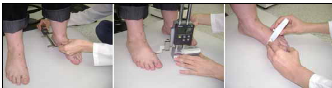
Figura 26 – Utilização de traçador de altura, paquímetro e fita métrica.
