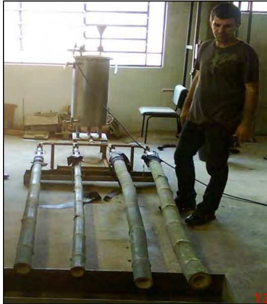
Figura 10 – Tratamento pelo método Boucherie
