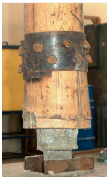
Figura 157 - Teste de tração na Conexão de Trujillo Fonte: CONBAM (2009)
