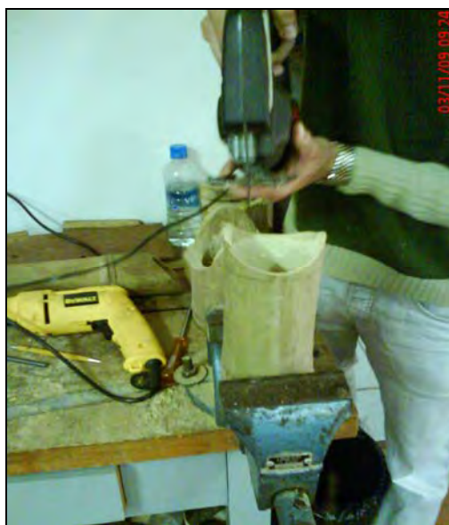
Figura 96 – Corte tipo boca-de-peixe, realizado com ferramental moderno
