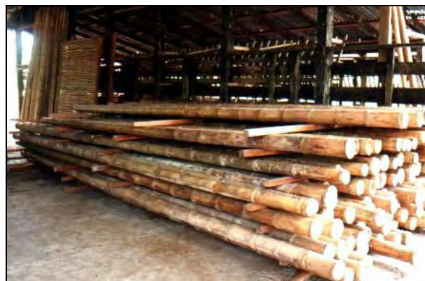
Figura 11 – Armazenamento correto das varas de bambu Fonte: Dunkelberg (1996).
