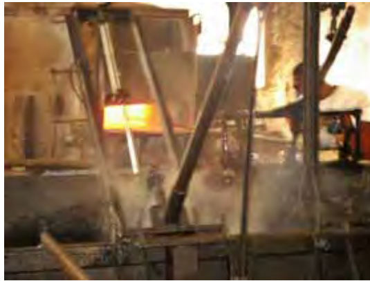
Figura 22: Lâmina sendo colocada no forno para tratamento térmico.
