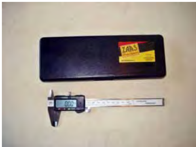
Figura 30 - Paquímetro utilizado nas medições das amostras
