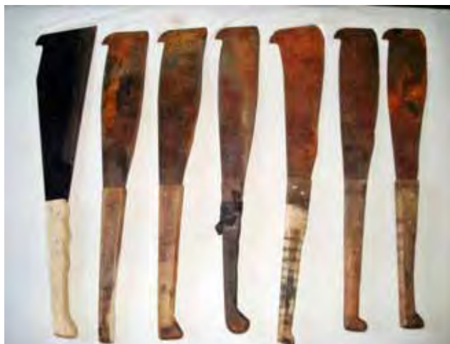
Figura 36: Sete facões da amostra inicial com diferentes tamanhos de cabo de madeira
