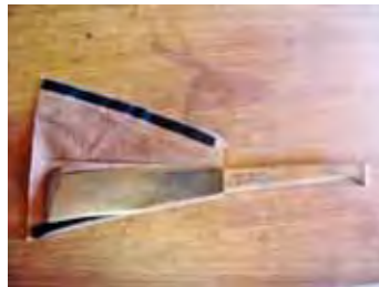
Figura 41: Bainha de segurança com lâmina de um facão já usado para baixo, modelo sistema carteira.
