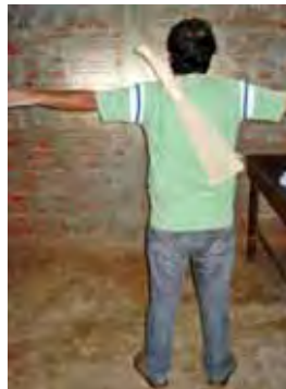
Figura 57: “Bainha de segurança Samurai” fixa e distribuída ao corpo, de forma adequada.
