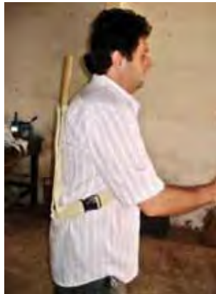
Figura 63: Bainha de segurança Samurai lateralmente com a fivela.
