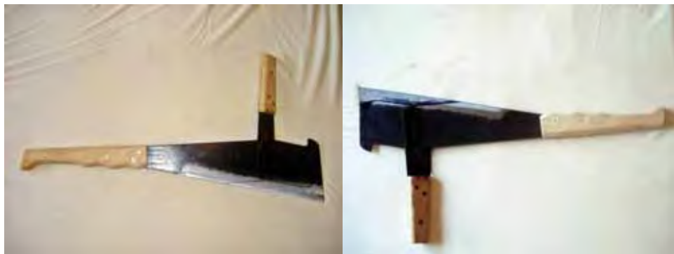
Figura 33: Facão com gabarito de uso fornecido pelo fabricante
