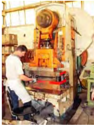
Figura 19: Guilhotina de corte da chapa de aço
