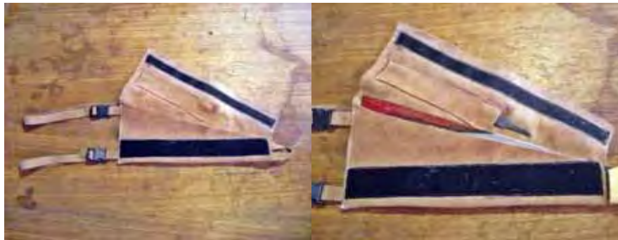
Figura 71: Bainha de segurança mochila com regulagem lateral de velcro e porta lima interno na capa da bainha.
