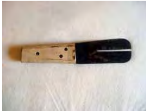
Figura 32: Gabarito para medir o tamanho máximo de desgaste da lamina
