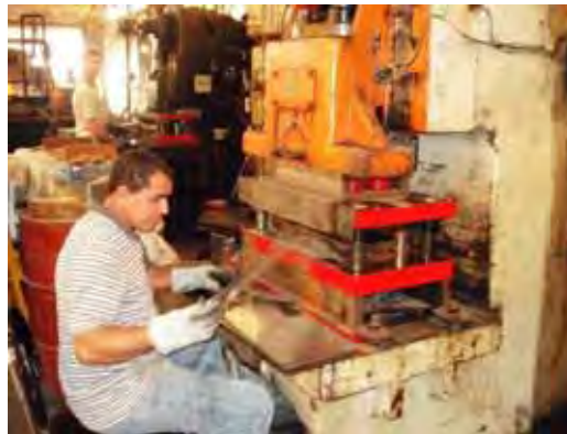
Figura 20: Prensa excêntrica cortando a lamina para o facão canavieiro.
