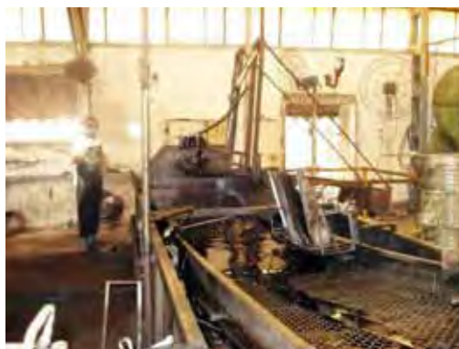
Figura 24: Resfriamento da lâmina para finalizar o processo de tempera.
