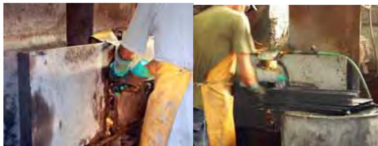
Figura 26: Afiando as laminas do facão canavieiro
