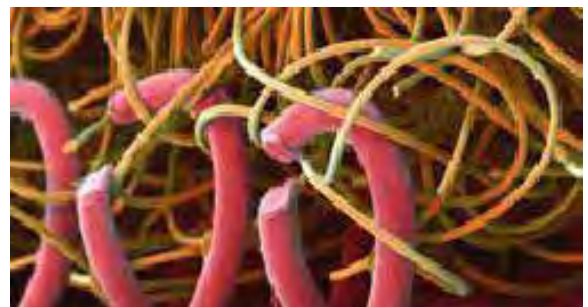
Figura 13: Ganchos preso a laços visto no microscópio
