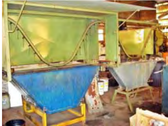
Figura 25: Tanques de imersão para limpeza e pintura.
