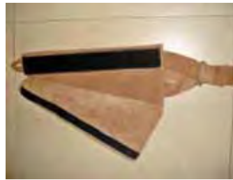
Figura 53: Bainha de segurança Samurai com velcro de regulagem.
