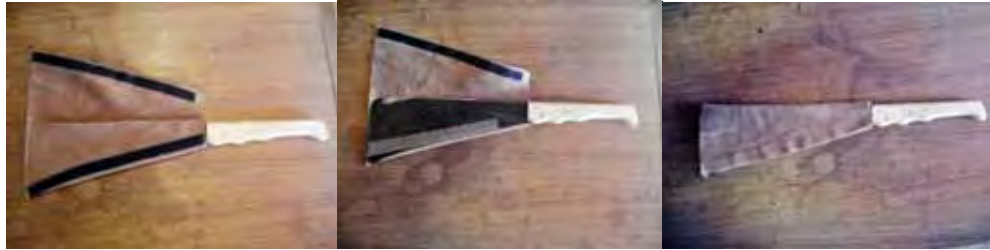
Figura 40: Bainha de segurança com facões standard e laminas para baixo, modelo sistema carteira.
