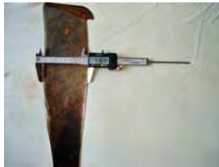
Figura 38: Medição de um dos pontos da largura da lâmina
