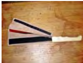
Figura 43: Bainha de segurança com espaço para regulagem, facão “standard”
