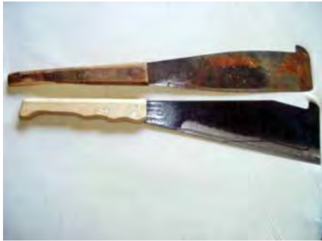
Figura 35: Facão encontrado na amostra com menor área de lâmina comparado ao facão no seu estado “standard”
