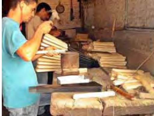
Figura 28: Fixação do cabo de madeira.
