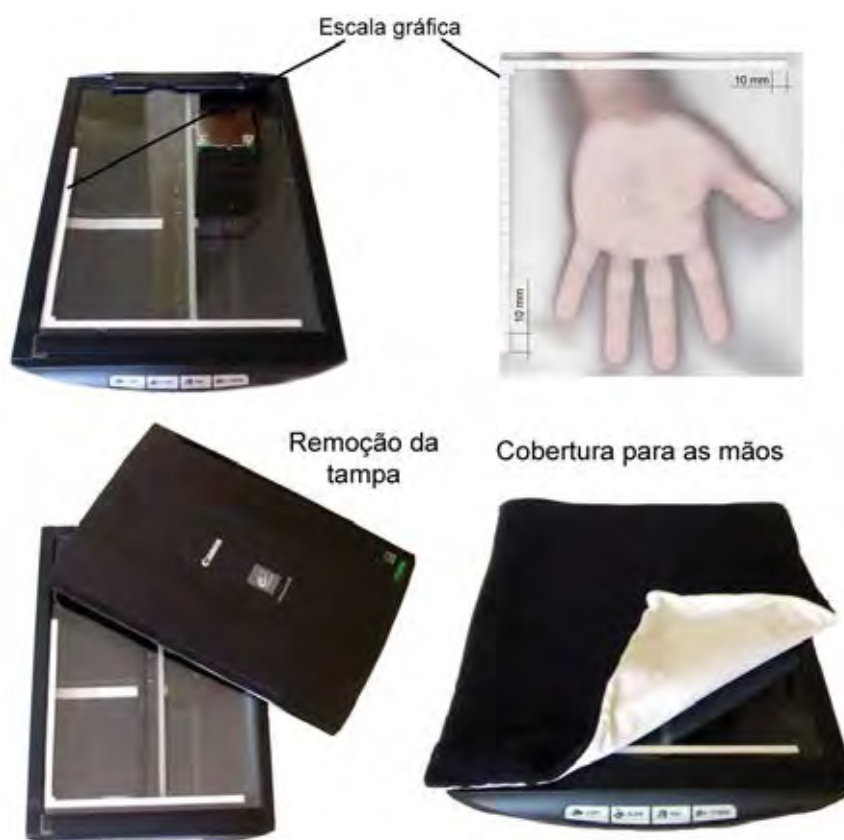
Figura 32 – Escala gráfica e cobertura para as mãos utilizadas nos procedimentos da Biofotogrametria.
