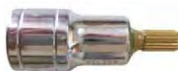
Figura 24 – Sistema de encaixe no transdutor de torque estático para os volantes.
