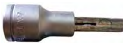
Figura 23 – Sistema de encaixe no transdutor de torque estático para as maçanetas.
