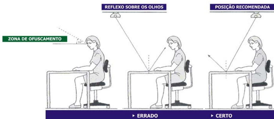
Figura 3.8.2 – As luminárias devem ficar posicionadas 30^\circ acima da linha de visão e atrás do trabalhador, para evitar ofuscamentos e reflexos. Fonte: lida, 2005.
