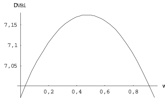
Figura 4.10 – Variação do consumo da manobra bi-impulsiva em função do ângulo \omega ( \theta = 0,95 \text{ rad} ).
