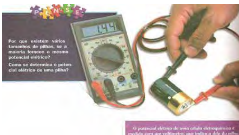
Figura 8 – Medida do potencial elétrico de uma pilha comum.
