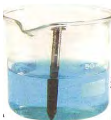
Figura 12 – Processo de deposição química do cobre metálico sobre o ferro (prego).
