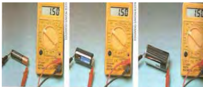
Figura 5- Medidas da fem de pilhas com diferentes tamanhos.
