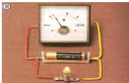
Figura 4 – Foto ilustrativa representando a medida da força eletromotriz de uma pilha.
