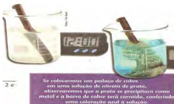
Figura 7 – Processo de oxido-redução de uma barra de cobre.
