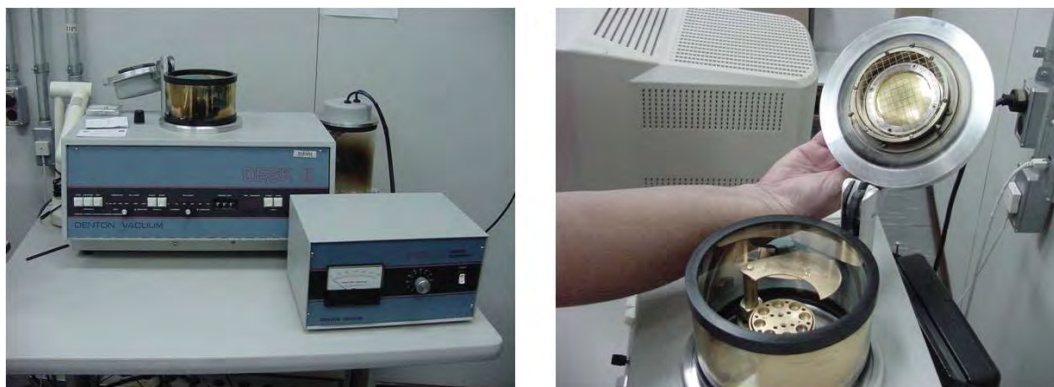
Figura 10 – Metalizadora para aplicação de ouro nos espécimes (Desk II, Denton Vacuum, JEOL Ltda, Tokyo, Japão).
