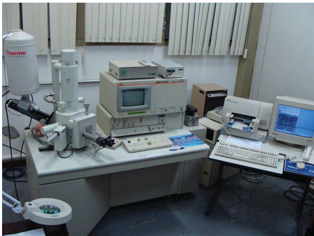
Figura 8 - Microscópio Eletrônico de Varredura (JEOL – JSM- T330A, Jeol Ltda, Tokyo, Japão).
