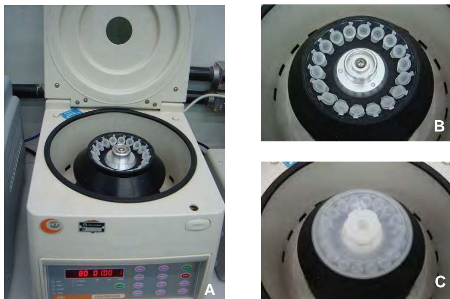
Figura 12 – a, b e c) posicionamento dos eppendorfs de 1,5 mL na centrífuga.
