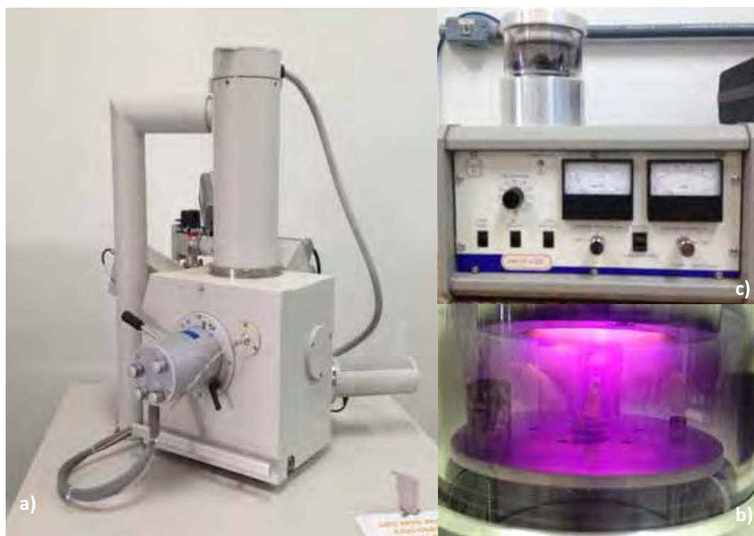
Figura 11 – a) Microscópio Eletrônico de Varredura utilizado para a obtenção das imagens; b) Aparelho utilizado para a metalização dos espécimes; c) Raiz passando pelo processo de metalização.
