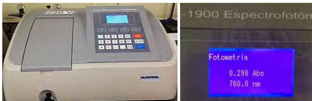
Figura 3 – Espectrofotômetro utilizado e especificações da fotometria.
