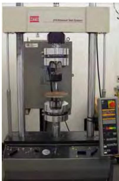
FIGURA 9 - Máquina de ensaios mecânicos - MTS 810.
