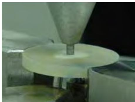
Ensaio Mecânico (*push-out*)
