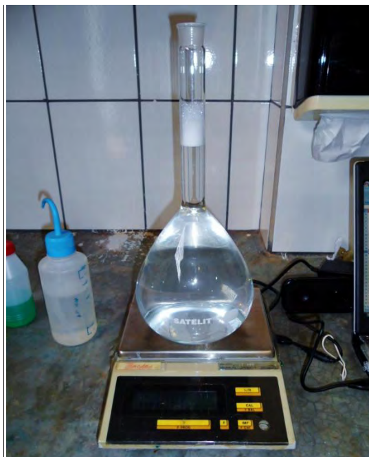
Figura 6. Determinação da massa de 2 L da calda a ser pulverizada
