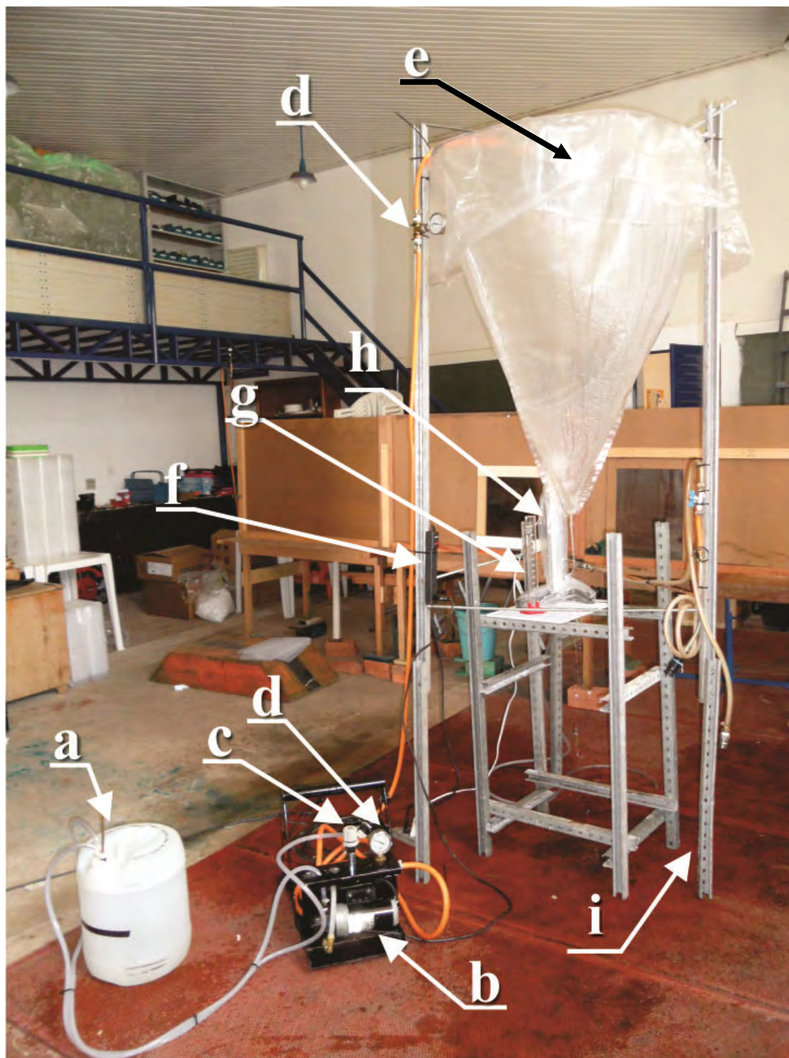
Figura 4. Esquema do sistema de pulverização montado sobre o funil coletor. a) reservatório de calda, b) bomba hidráulica, c) válvula estranguladora, d) manômetro, e) posicionamento da ponta, f) interruptor da bomba, g) proveta, h) luz fluorescente, i) estrutura de sustentação.
