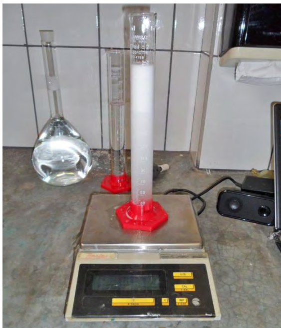
Figura 9. Determinação da massa da calda coletada.
