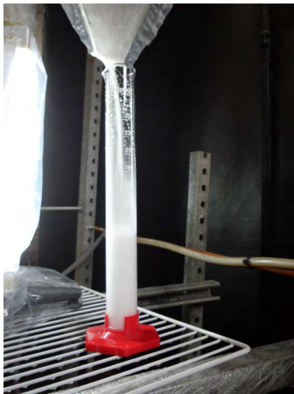
Figura 7. Coleta da pulverização capturada pelo funil.
