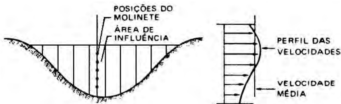
Figura 5. Traçado do perfil da seção transversal para medição da vazão com molinete.
